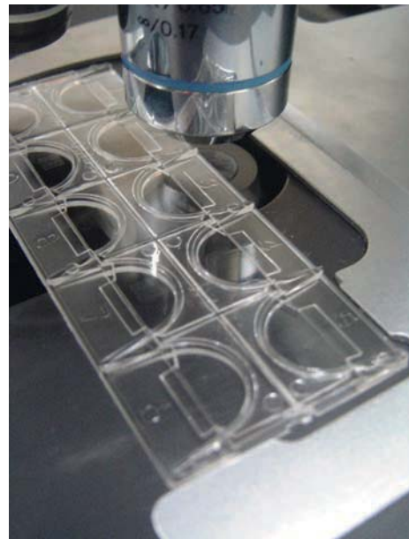
Fig. 3.3 Cellule Kovalslide® sur la platine d'un microscope.
